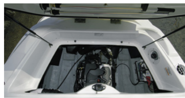
Zwischen Motorraum und Motorraum-Abdeckung befindet sich eine herausnehmbare GFK-Schale, in der Handtücher und andere Utensilien Platz finden.
